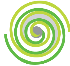
随着涡旋盘继续作行星运动, 气体被压入越来越小的空间
